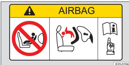
Abb. 1 Airbag-Aufkleber an der Sonnenblende (Prinzipdarstellung).
