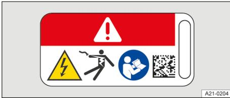
Abb. 4 Warnschild auf Hochvoltkomponenten.
